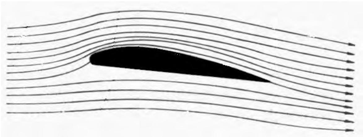
**Figura 5.1. Flujo laminar de un fluido perfecto en torno al perfil de un objeto**
