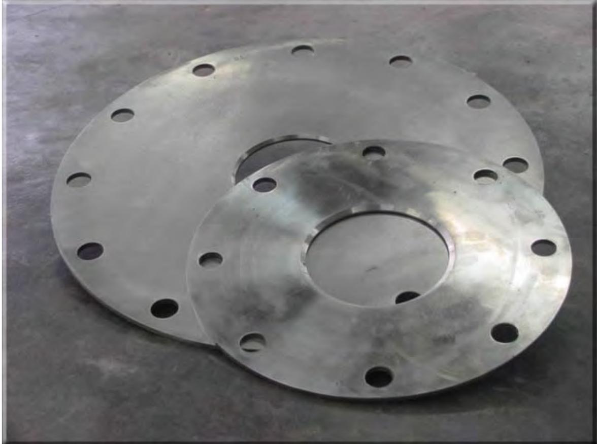
**Figura 6.1. Placas de orificios**
